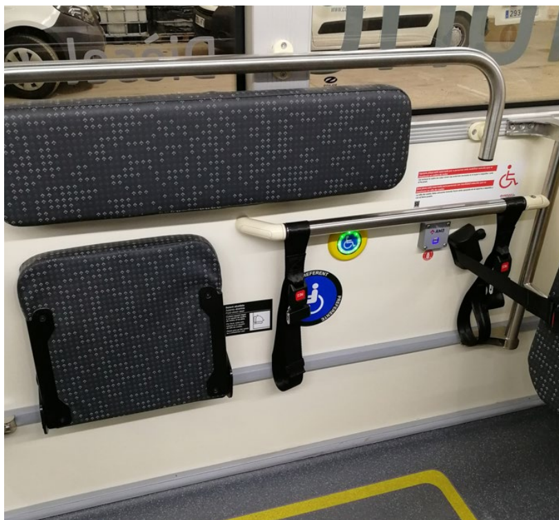
Figura 28. Cinturones de seguridad, asideros strap y respaldo acolchado zona PMR-SR
