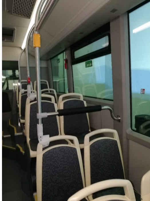
Figura 24.- Barra de protección para que en el caso de desaceleración brusca y su protección
