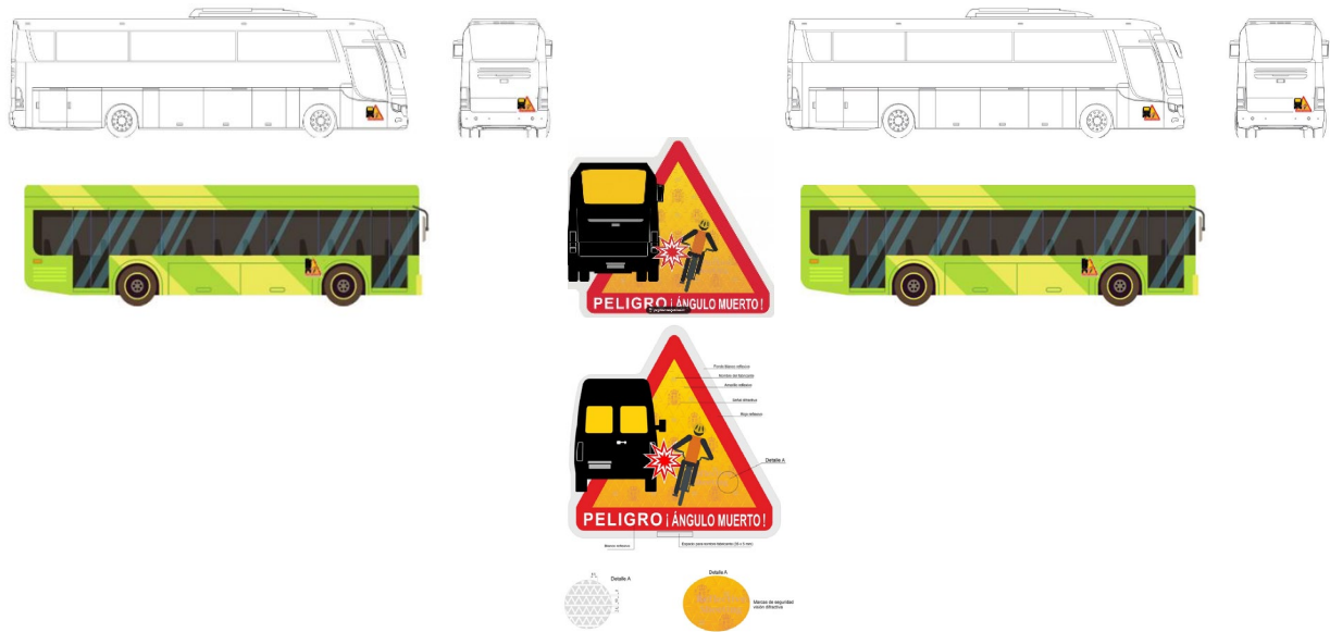
Figura 22.- Señalización ángulo muerto. Conforme a instrucción VEH 21/05.
