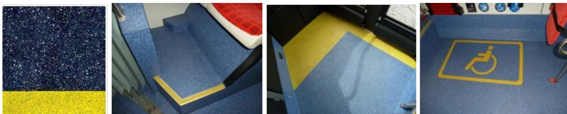
Figura 8.- Señalización esquinas y escalones
