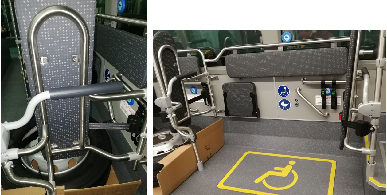
Figura 29. Barra abatible (anti-vuelcoc) zona PMR-SR
